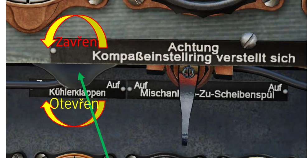
Ruční ovládání klapky chladiče
